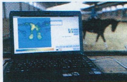
Das Signal der Messmatte unterm Sattel wird vom Pferderücken per Funk auf den Computer übertragen.
